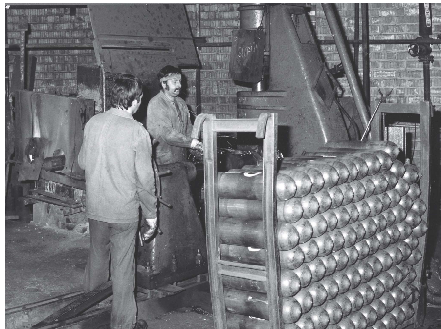
Obr. 1: Práce na vzduchovém bucharu.
