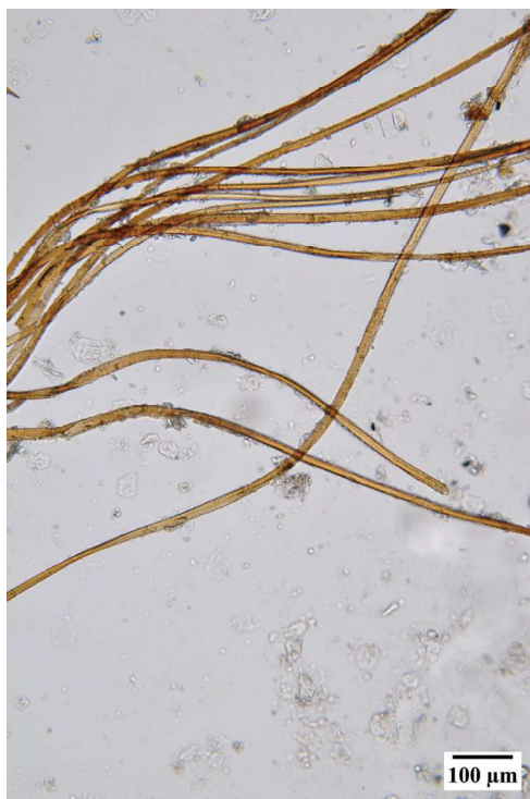
Obr. 2: Vlákna pod mikroskopem ve VIS (zvětšeno 200x). Foto autorka.
