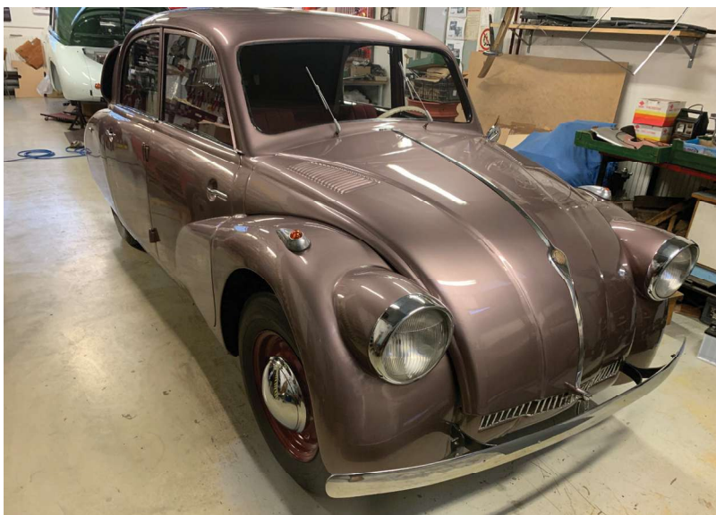
Obr. 5: Tatra 97, nevhodná renovace z 90. let 20. století, ztráty autenticity originálního materiálu, nevhodná barevnost a technologie. Foto M. Bortlová.
