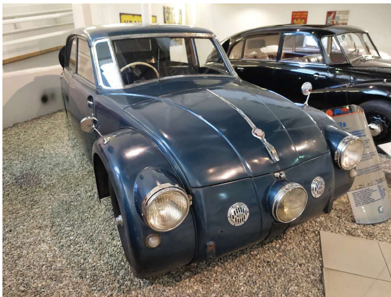
Obr. 2: Tatra 77a v expozici muzea, autentický provozní stav z doby po ukončení provozu na konci 60. let 20. století, druhotný lak, chybějící přední nárazník a náhradní zadní kapota z Tatry 87, přesto se jedná o jednu z nejautentičtějších a tedy nejcennějších dochovaných Tater 77a.
